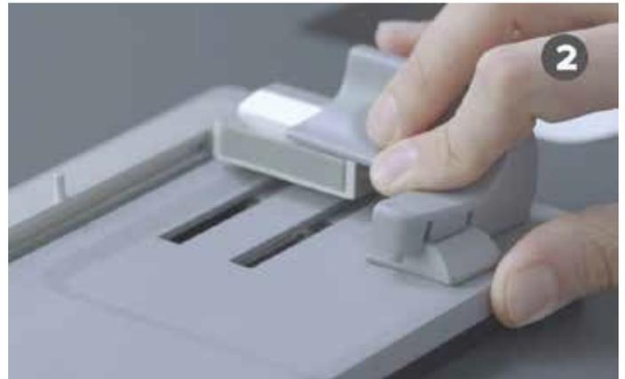
Colocar el separador móvil en función de las teclas laterales del smartphone
