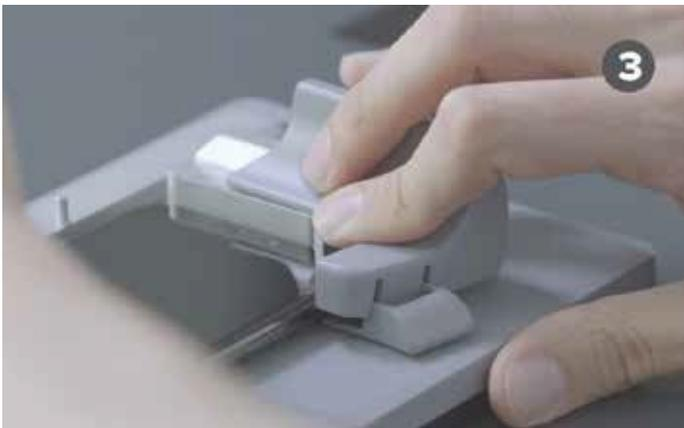
Pulsar el tope inferior para desbloquearlo y fijar el smartphone en posición
